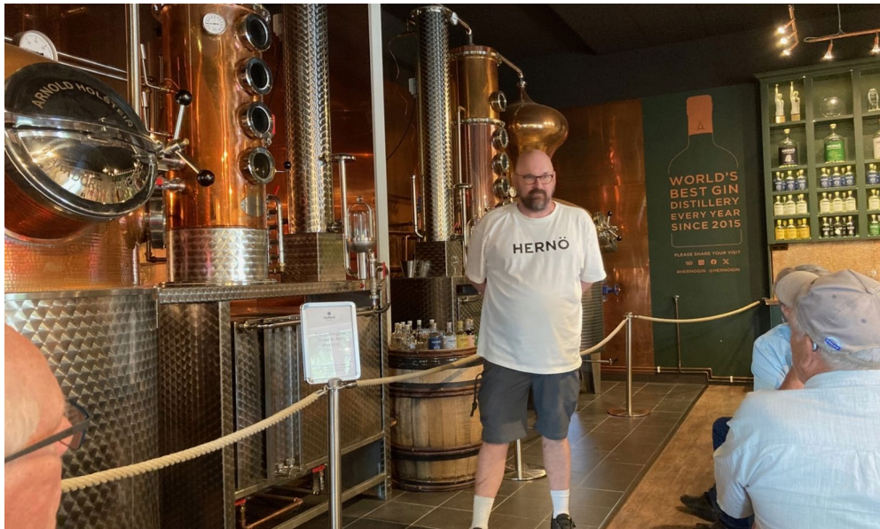
Bild 2. Den utmärkta presentationen skedde i anslutning till den tvådelade destillations-anläggningen som blänkte vackert. Processen börjar i ytterkanten och den färdiga produkten kommer ut i mitten.
